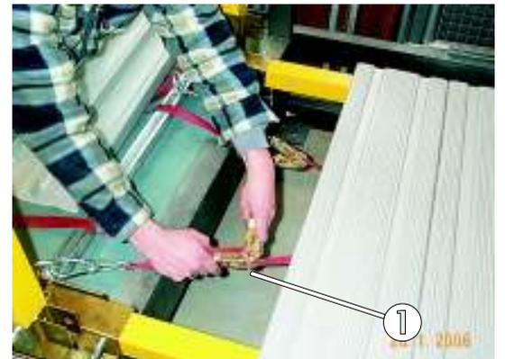
Bild 33: Gleichmässiges Aufbringen der maximalen Spannkraft.
