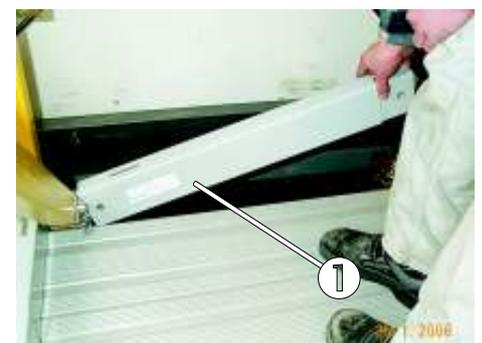
Bild 69: Montage der stirnseitigen Fußleiste
