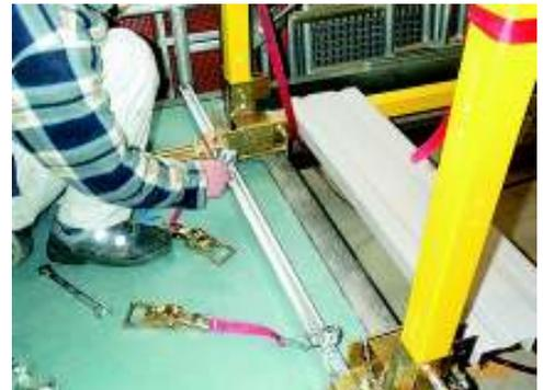
Bild 24: Die Kurzstücke werden jeweils mit Hilfe eines Karabinerhakens fixiert
