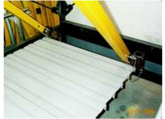
Nach der vorletzten Paneele werden die Spanngute mit Hilfe der Ratsche auf maximalen Zug gebracht (Bild 33 / Pos. 1). Hierbei sollte auf eine Gleichverteilung der Spannkraft auf beide Gurtstränge geachtet werden.
