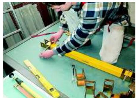
Auf die Gleichrichtung und die Kettenführung der Steckbolzen sollte geachtet werden (Bild 50 / Pos. 1).
