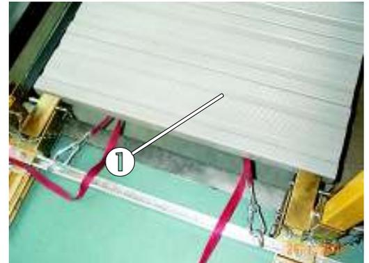
Bild 37: Fixierung der kurzen Spannurgurthälfte
