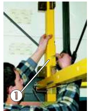
Bild 81: Sicherung der oberen senkrechten Geländerstütze
