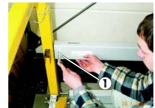
Auch für die Knieleiste stehen an den hinteren senkrechten Geländerstützen U-Profile zur Befestigung mit kurzen Steckbolzen zur Verfügung. Durch Herausziehen des Innenrohres kann die gewünschte Länge dargestellt werden (Bild 70 / Pos.1).
