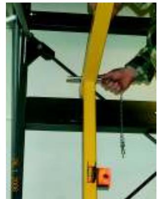
Das Handlauf-Außenrohr bleibt bei allen Bühnentiefen gleich.
