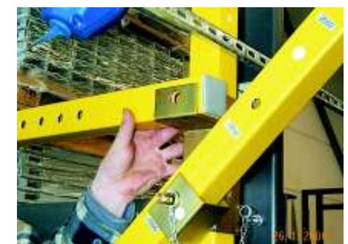
Auf die Gleichrichtung und Kettenführung der Steckbolzen sollte geachtet werden.
