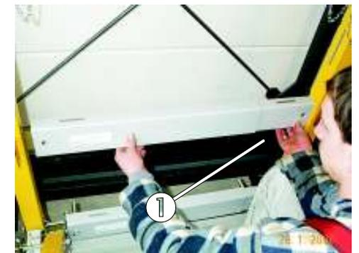
Bild 70: Befestigung der stirnseitigen Knieleiste
