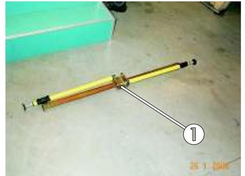
Bild 74: Teleskopstangen (gelb) inklusive Adapter
