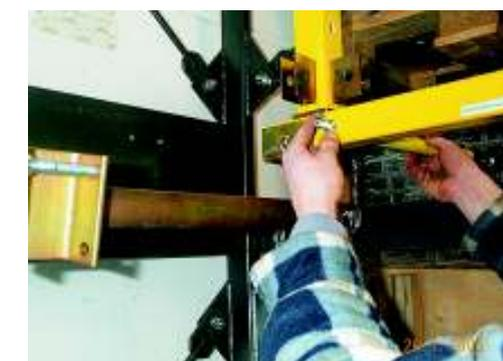
Soll die Teleskopstange am oberen waagrechten Aufleger montiert werden, ist die mitgelieferte große Unterlegscheibe zu verwenden.
