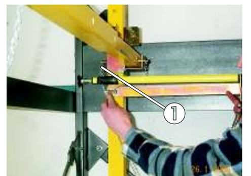
Bild 78: Öffnen und Schließen des Festhaltehebels
