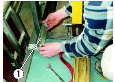
Bild 43: Anbringung des zweiten L-Profils
