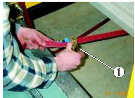
Bild 27: Mit Hilfe der Ratsche wird der Zurrurt auf geringe Vorspannung gebracht
