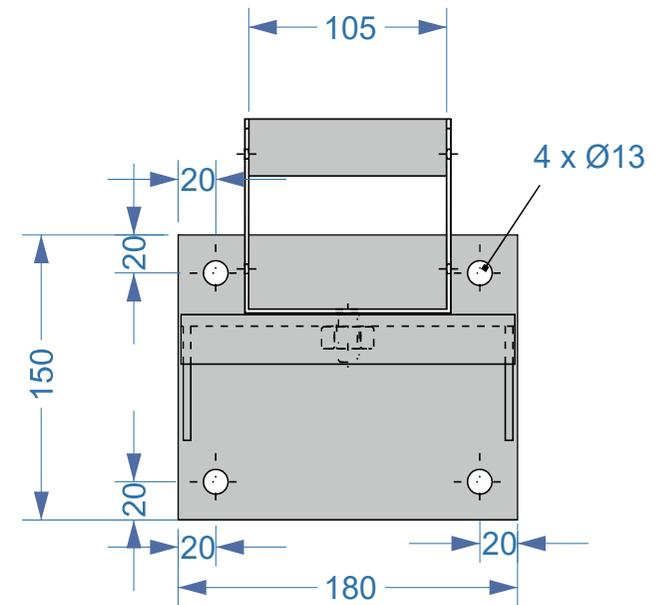
In Beton C20/25 Dübelbefestigung mit 4 Steckanker-Dübel HILTI HST M12/20 (oder gleichwertig mit Nachweis)
