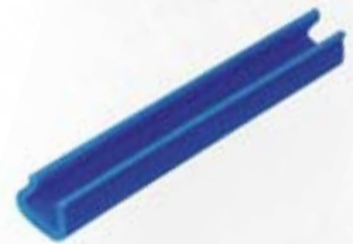
Details: PE-Schaum Farbe: blau Standardlänge: 2m ±2% Lichtes Innenmaß: max. 92mm Materialstärke: 18mm Verpackungseinheit: 72m
