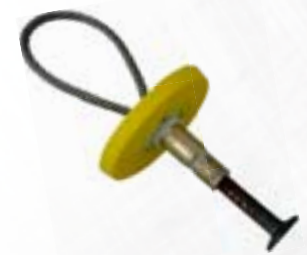
Details PFEIFER-Fußanker: Höhe 165mm (Rd 20), übergroßer Kunststoff-Nagelteller, Datenclip, Seilöse lange Form, Fußanker mit Seilöse komplett montiert
