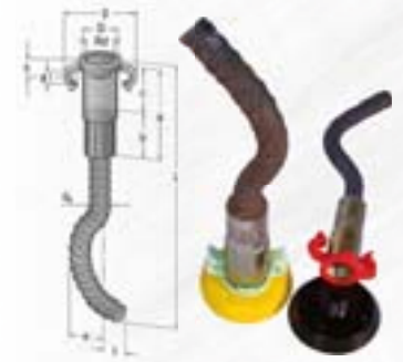
Details: Hülse aus Präzisionsstahlrohr in Sondergüte, verzinkt oder aus Edelstahl 1.4571, verpresst mit Betonstahl BSt 500 S, schwarz; Nagelteller und Datenclip aus Kunststoff
