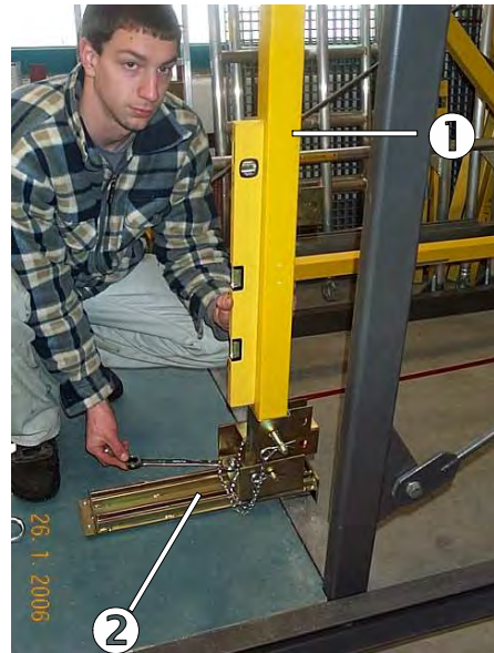
Fig. 3 : Côté vertical avant du triangle inséré dans l'articulation de seuil montée.
