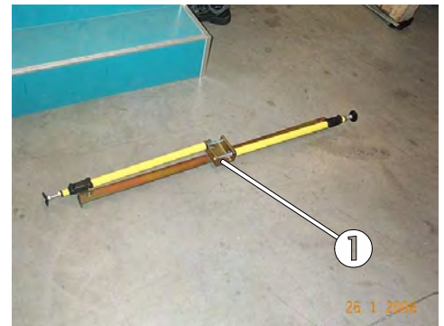
Fig. 66 : Barres télescopiques (jaune) incluses adaptateur
