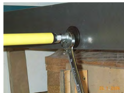
Fig. 71 : Pied réglable pour un réglage fin de la longueur
