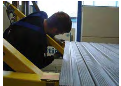
Fig. 82 : Colliers de serrage contre le glissement des panneaux de plancher
