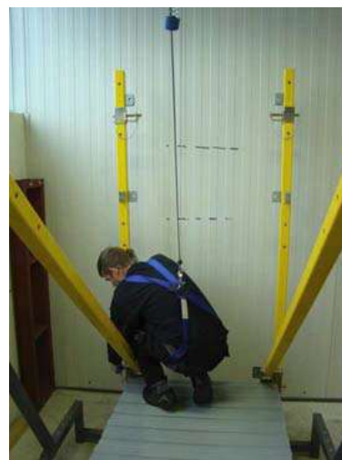
Fig. 48 : Sécurisation avec un goujon enfichable court
