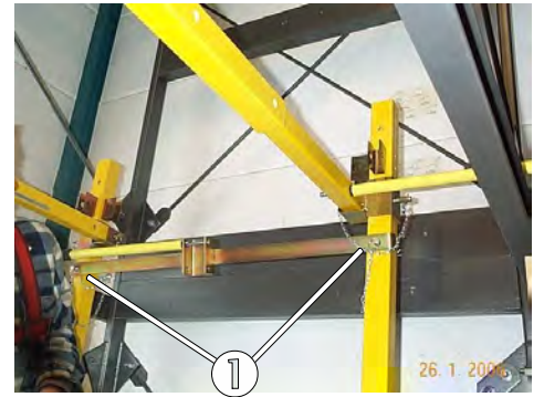
Fig. 67 : Fixation de l'adaptateur
