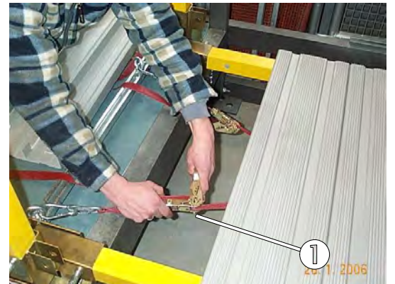
Bild 33: Gleichmässiges Aufbringen der maximalen Spannkraft.
