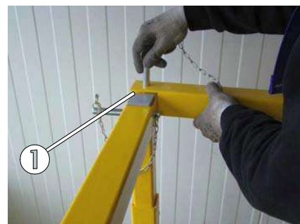
Fig. 90 : Le goujon enfichable est inséré par le haut, pour sécurisation
