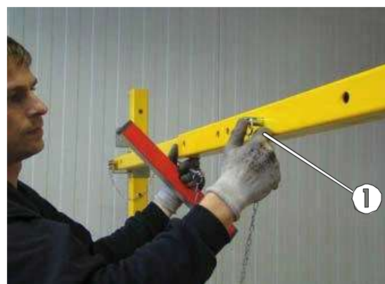
Fig. 60 : Fixation de l'intérieur et de l'extérieur du tube avec un goujon court
