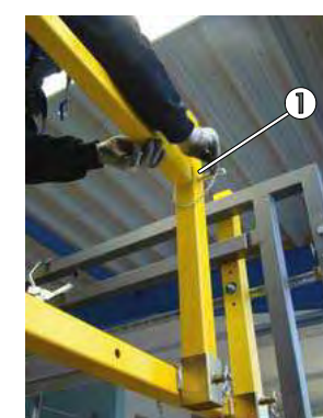
Fig. 87 : Le tube intérieur de la main courante est inséré dans le montant du garde-corps vertical avant et fixé avec un goujon
