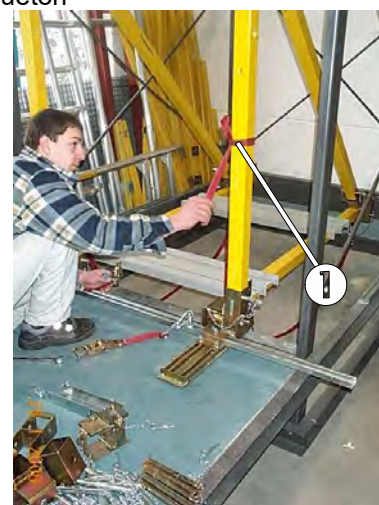
Fig. 25 : Détachement de la seconde moitié de la sangle d'arrimage
