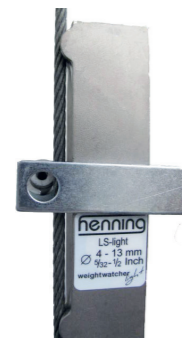
Einbringen des Lastsensors LS-light in das Seil
