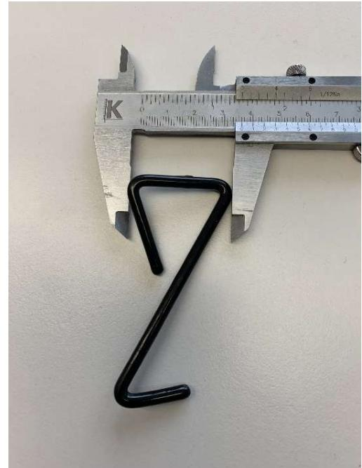
Selon la conception du pli, un de nos crochets métalliques peut être utilisé. Si des crochets métalliques sont utilisés, des œillets de suspension métalliques sont alors prévus sur la face supérieure du revêtement. Chez STINGL/KAPOK88, nous déterminons pour vous le nombre de crochets métalliques requis, par côté de cabine. Toutefois, vous pouvez aussi indiquer vos consignes sur notre fiche de réception.
