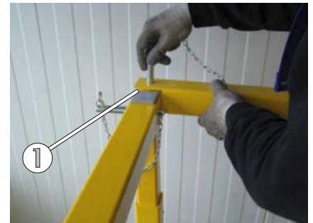
Bild 90: Der Steckbolzen wird zur Sicherung von oben eingeführt
