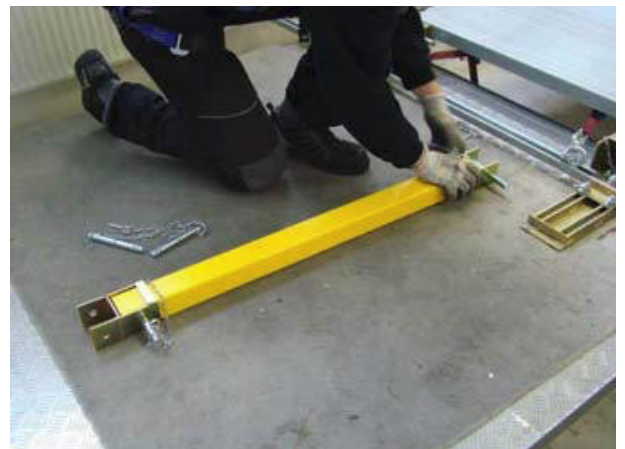
Bild 49: Vormontage des stirnseitigen Auflegers
