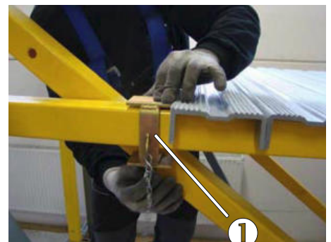
Bild 82: Rohrklemmen gegen das Verrutschen der Bodenpaneele
