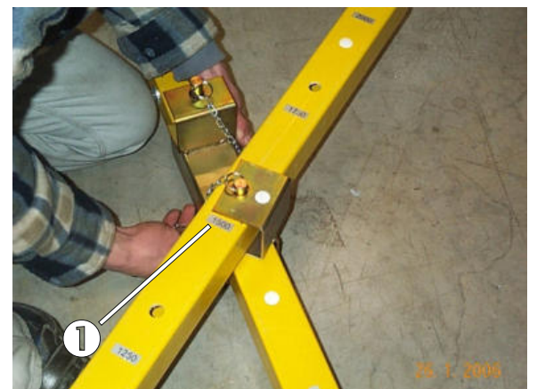
Bild 10: Einstellung der Bühnentiefe
