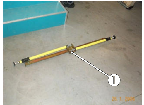
Bild 66: Teleskopstangen (gelb) inklusive Adapter
