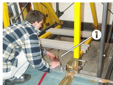
Bild 30: Gurte unter Vorspannung bringen
