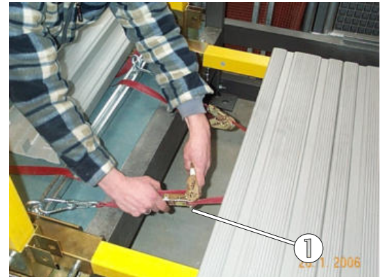
Bild 33: Gleichmässiges Aufbringen der maximalen Spannkraft.
