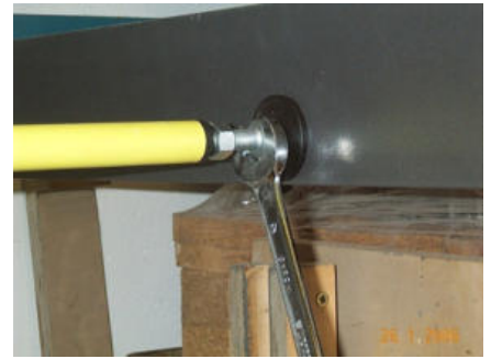
Bild 71: Stellfuß zur Feinjustierung der Länge
