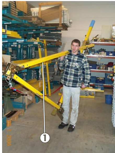
Bild 12: Transport des Dreieckselementes
