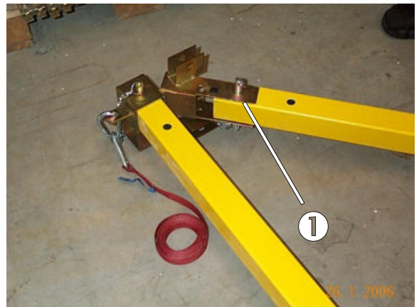
Bild 9: Fixierung des diagonalen Profils
