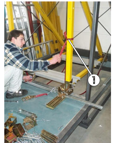
Bild 25: Lösen der zweiten Spanngurthälfte
