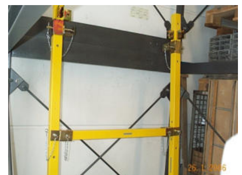
Bild 52: Steckbolzen zur Sicherung des Längsauflegers
