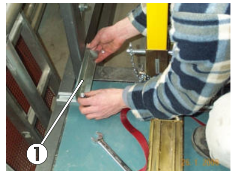
Bild 43: Anbringung des zweiten L-Profils
