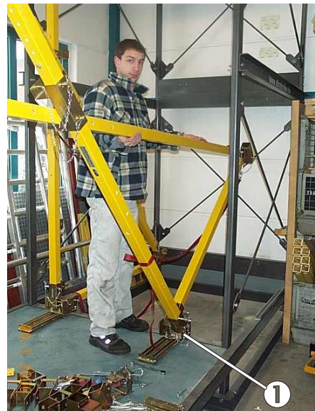
Bild 13: Absetzen auf die Türschwelle
