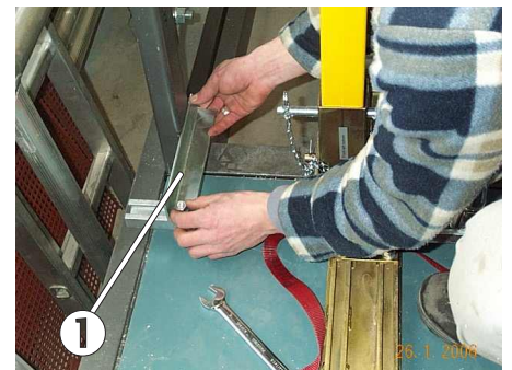
Bild 43: Anbringung des zweiten L-Profils
