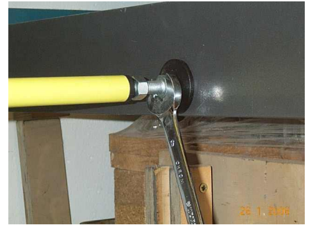
Bild 71: Stellfuß zur Feinjustierung der Länge
