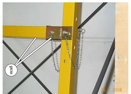
Bild 53: Gleichgerichtetes Stecken der Bolzen
