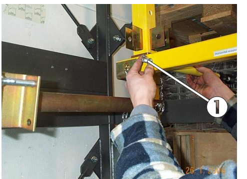
Bild 69: Alternative Befestigung der Teleskopstangen
