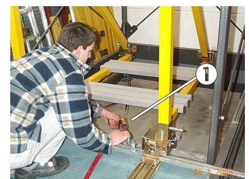
Bild 30: Gurte unter Vorspannung bringen
