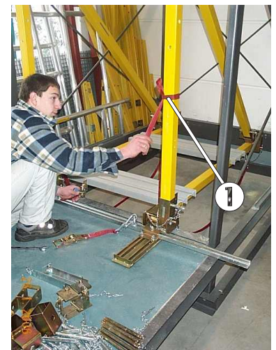
Bild 25: Lösen der zweiten Spanngurthälfte
