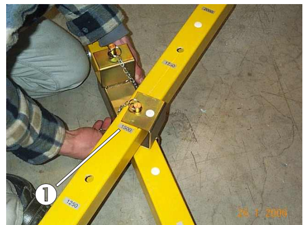
Bild 10: Einstellung der Bühnentiefe
