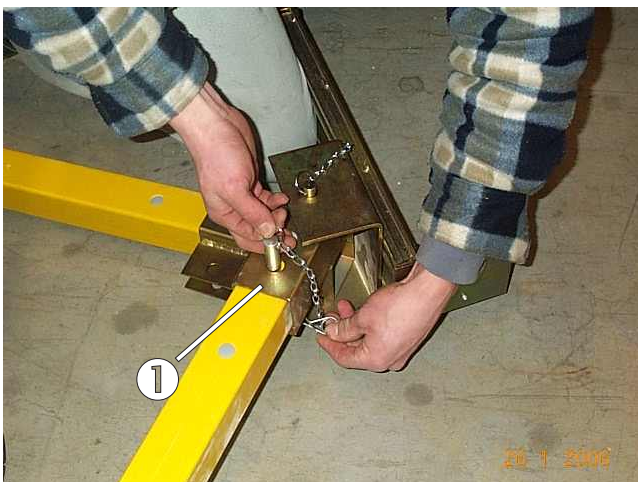
Bild 6: Senkrechte und waagrechte Dreiecksseite mit dem linken Schwellenwinkel verbunden
