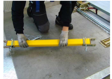
Bild 49: Vormontage des stirnseitigen Handlaufes
