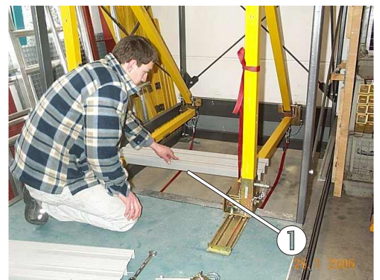
Bild 16: Erste Standardpaneele auflegen
