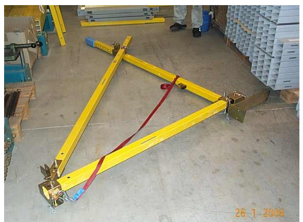
Rechtes Dreieckselement im montierten Zustand
