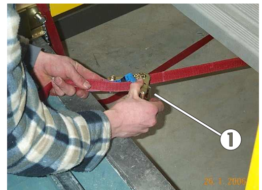
Bild 27: Mit Hilfe der Ratsche wird der Zurrigurt auf geringe Vorspannung gebracht
