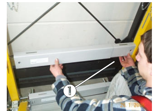
Bild 70: Befestigung der stirnseitigen Knieleiste
