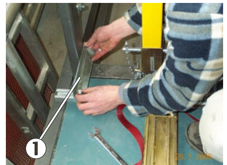
Bild 43: Anbringung des zweiten L-Profils
