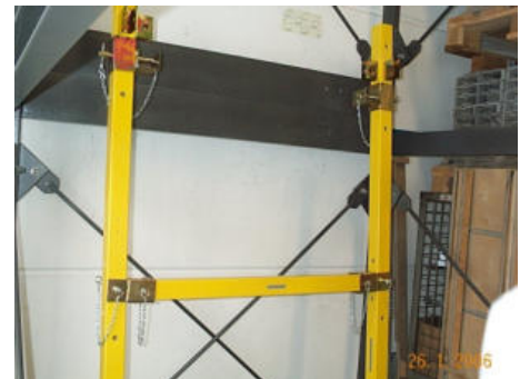
Bild 52: Steckbolzen zur Sicherung des Handlaufes
