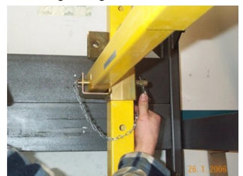
Bild 56: Vorderes Aufnahmeteil zur Fixierung Auflegers
