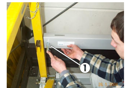
Bild 70: Befestigung der stirnseitigen Knieleiste
