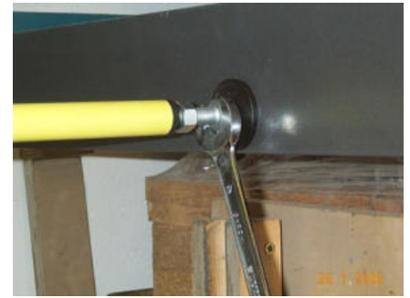
Bild 79: Stellfuß zur Feinjustierung der Länge
