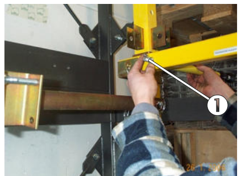
Bild 77: Alternative Befestigung der Teleskopstangen
