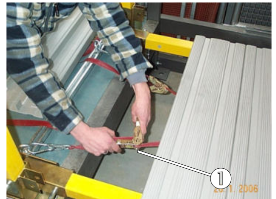
Bild 33: Gleichmässiges Aufbringen der maximalen Spannkraft.
