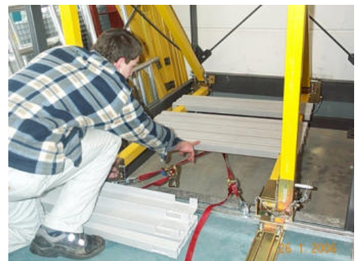
Bild 32: Auflegen weiterer Bodenpaneele
