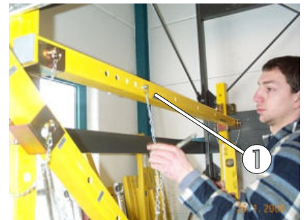
Bild 60: Fixierung von Innen- und Außenrohr mit einem kurzen Bolzen
