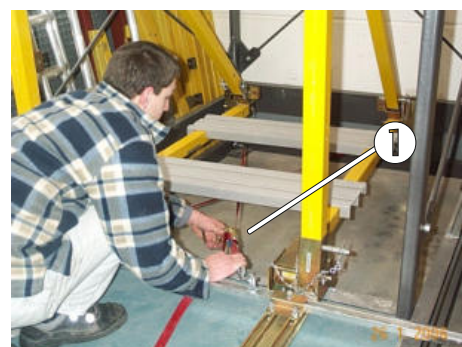
Bild 30: Gurte unter Vorspannung bringen
