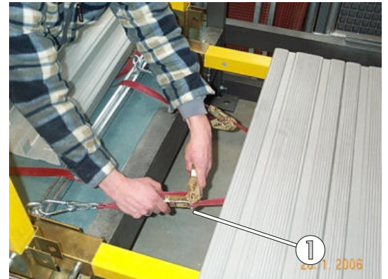
Bild 33: Gleichmässiges Aufbringen der maximalen Spannkraft.
