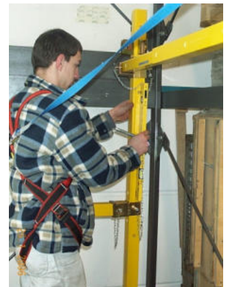
Bild 60: Fixierung von Innen- und Außenrohr mit einem kurzen Bolzen
