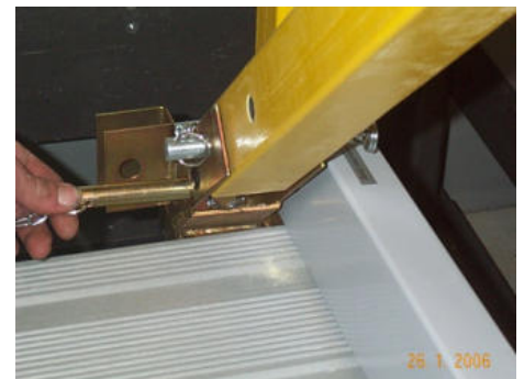
Bild 68: Verwendung eines langen Steckbolzen zur Fixierung der Fussleiste hinten rechts
