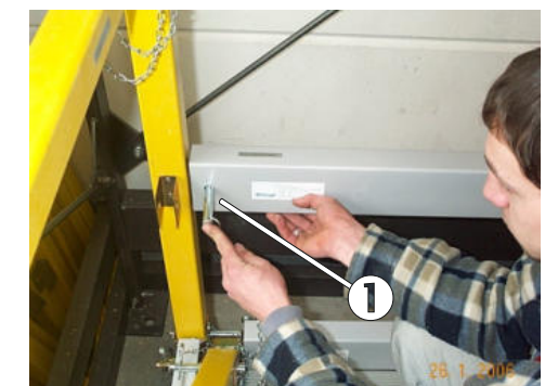
Bild 70: Befestigung der stirnseitigen Knieleiste
