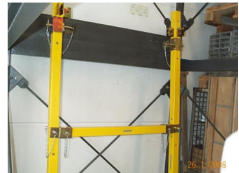
Bild 52: Steckbolzen zur Sicherung des Handlaufes
