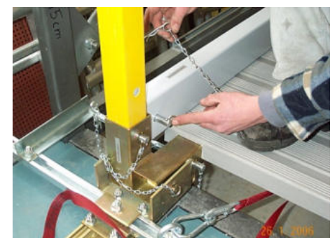
Bild 67: Fixierung der Fußleiste hinten mit einem langen Steckbolzen
