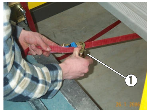
Bild 27: Mit Hilfe der Ratsche wird der Zurrgrut auf geringe Vorspannung gebracht
