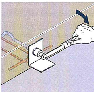
Maximale Montagedrehmomente max.  $T_{inst}$
