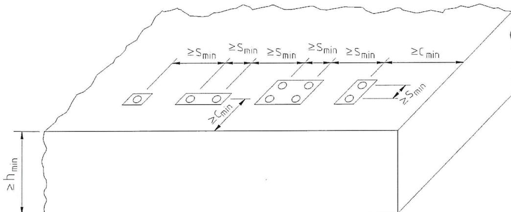
Für den Einbau der Anker in die Stirnseite eines Bauteiles gelten die Achs- und Randabstände sowie die Mindestbauteildicken sinngemäß.
