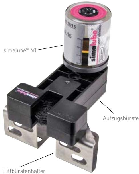
**SCHMIERUNG VON FÜHRUNGSSCHIENEN:** Das simalube® Schmier- und Reinigungssystem pflegt die Führungsschiene optimal. Es schützt die Schiene mit einem gleichmäßigen Ölfilm und reinigt sie gleichzeitig. Die simalube® Aufzugsbürste wird direkt am Kabinendach oder am Führungsschuh befestigt.
